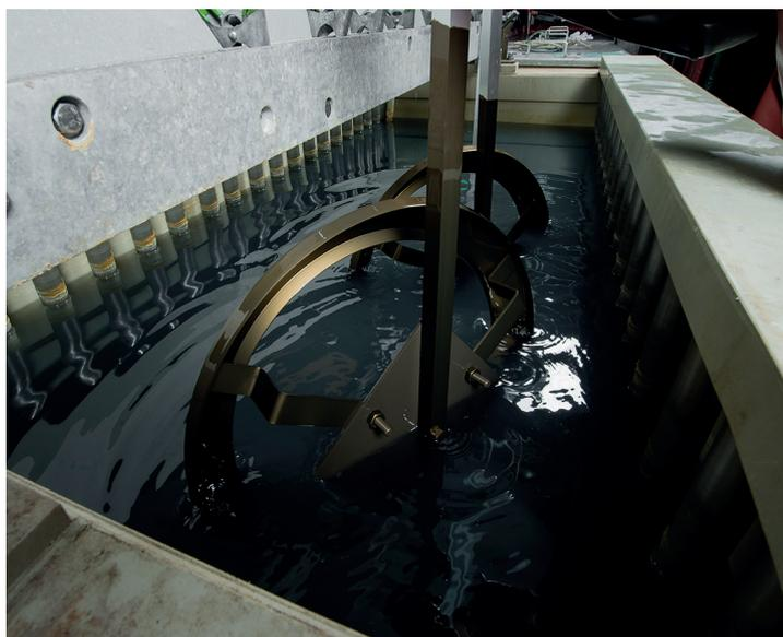
Oben: Das Eloxal-Verfahren ermöglicht, die Schutzschicht mit Farbstoffen zu mischen und den Leuchten ihre edle Färbung zu geben.
